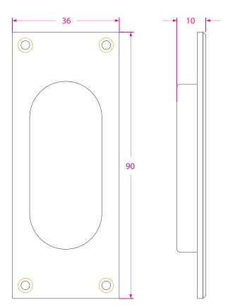
Medidas en mm / Dimensions in mm (1 inch = 25,4 mm)
