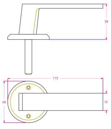
Medidas en mm / Dimensions in mm (1 inch = 25,4 mm)
