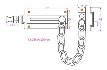
Medidas en mm / Dimensions in mm (1 inch = 25,4 mm)
