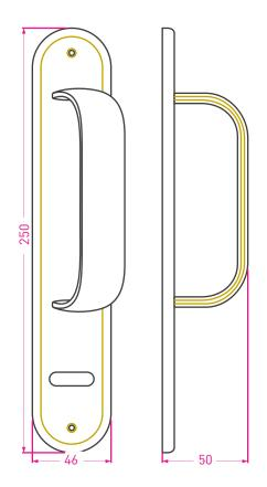
Medidas en mm / Dimensions in mm (1 inch = 25,4 mm)
